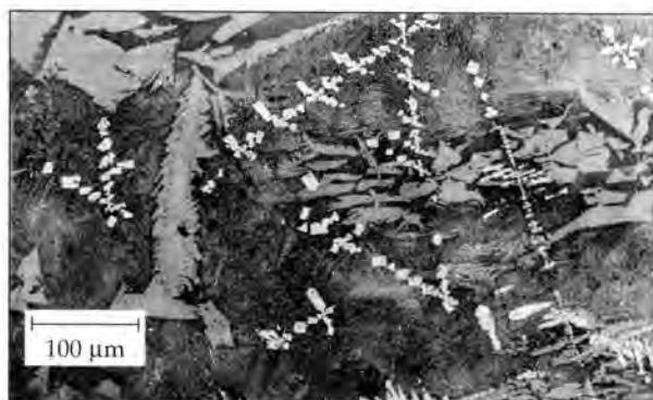
Obr. 18 - Kremičitanová štruktúra trosky s jemnými dendritmi wüstitu, vzorka č. 9.
