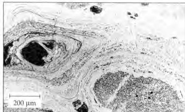
Obr. 16 - Korózne splodiny väčšieho kúsku železa v štruktúre trosky, vzorka č. 1.
