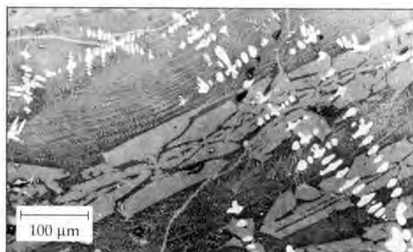
Obr. 17 - Kremičitanová štruktúra trosky s jemnými dendritmi wüstitu, vzorka č. 5.
