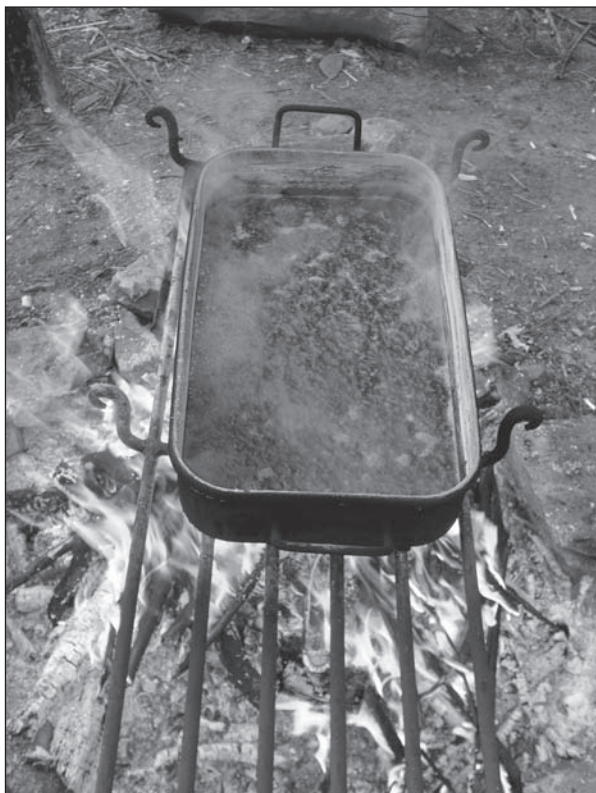
Obr. 5. Experimentální výroba potaše - odpařování výluhu z popela kapradin. Uhřínov pod Deštnou. Foto: J. Woitsch 2005.
