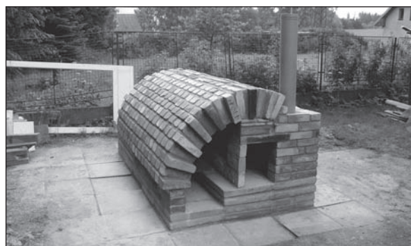
Obr. 7. Experimentální výroba potaše - kalcinační pec. Deštné v Orlických horách. Foto: J. Woitsch 2004.
