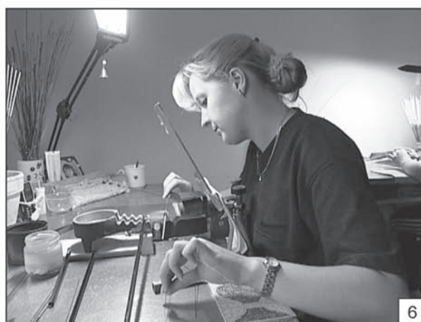
Obr. 1. 1 - ruční tažení skleněných tyčí v maxovské sklárně závodu Jizerské sklo, a. s., Lučany nad Nisou; 2 - dělení skleněných tyčí určených pro výrobu bižuterie před jejich temperováním, Dolní Maxov; 3 - Liboš Štrýncl u Kopalova mačkadla z přelomu 19. a 20. století, Maršovice; 4 - detail mačkárenského lisu L. Štrýncla, Maršovice; 5 - mačkáři v dílně Rudolfa Nikla, Jistebko; 6 - navíječka perlí ve firmě Rudolfa Nikla mladšího, Jablonec nad Nisou. Foto: T. Petrář, 2003.
