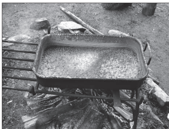
Obr. 6. Experimentální výroba potaše - závěrečná fáze odpařování výluhu z popela z kapradí. Uhřínov pod Deštnou. Foto: J. Woitsch 2005.
