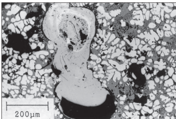
Obr. 5. Dendrity wüstitu v kremičitanovej matrici a koróznny zvyšok v štruktúre vzorky HL2. Abb. 5. Dendriten von Wüstit in der Silikat-Matrize und Korrosionsüberreste in der Probestruktur HL2.
