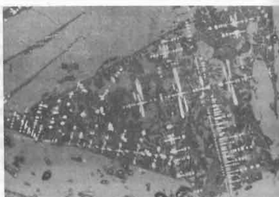
Obr. 15. Štruktúra, typická pre pecnú trosku, v troske z hradiska Malá Kopaňa (1 — 1 \mu\text{m} ).
