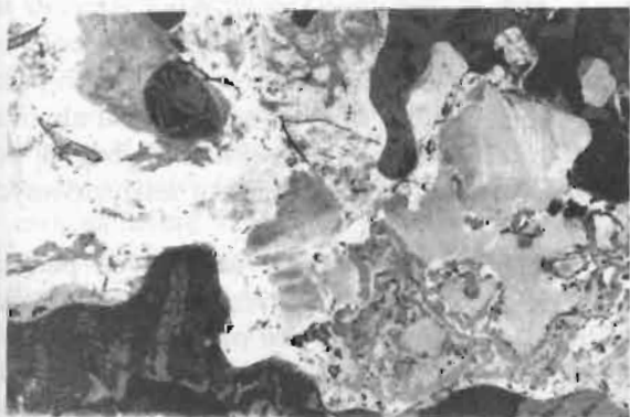
Obr. 9. Pozostatky korózie kúsku železa v štruktúre trosky z náleziska Novoklinovo (1 — 1 \mu\text{m} ).
