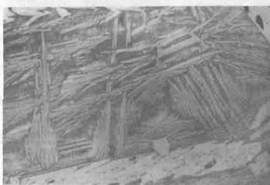
Obr. 17. Kremičitanová štruktúra, tvorená jemnými ihlicami železovápenatých olivínov, v troske z hradiska Malá Kopaňa (1 — 1 \mu\text{m} ).
