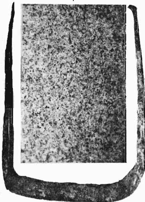
Obr. 1. Vršatské Podhradie. 1 — feritická struktura sekery s malým množstvím perlitu; 2 — feritická struktura sekery s množstvím nečistot; 3 — sekera (šipkou je naznačeno místo výbrusu); 4 — feriticko-perlitická mikrostruktura pořízu; 5 — poříz (šipkou je naznačeno místo výbrusu). Výbrusy jsou zvětšeny 100×.
