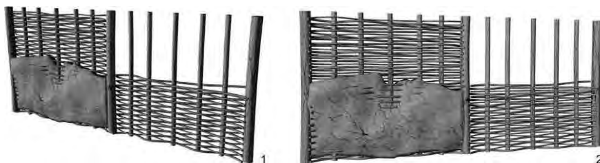
Obr. 14. Chynorany. Ideálna rekonštrukcia prúteného výpletu steny s hlineným výmazom z domu 2. Digitálny model vytvoril A. Arpáš.
