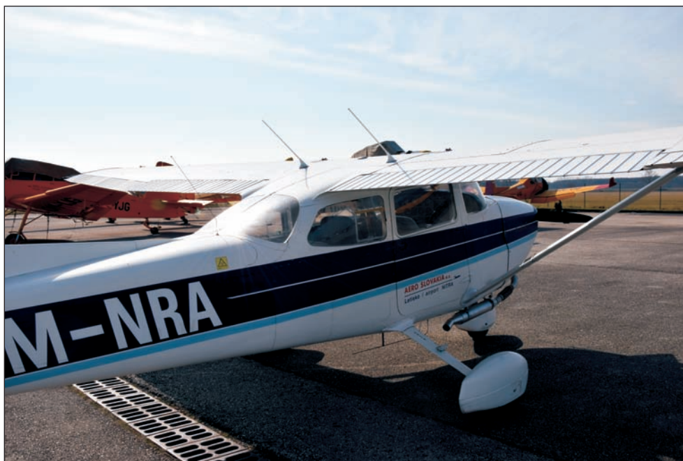
Obr. 2. Lietadlo-Cessna 172. Najčastejšie využívaný prostriedok na šikmé snímkovanie terénu a archeologických nálezísk. Foto: AÚ SAV – B. Balžan.
