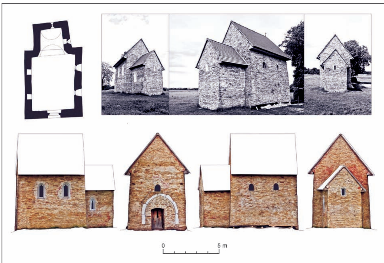
Obr. 16. Kopčany-Kostol sv. Margity Antiochijskej. Príklad spracovania 2D výstupu z 3D dokumentácie. AÚ SAV – A. Arpáš, B. Balžan.
