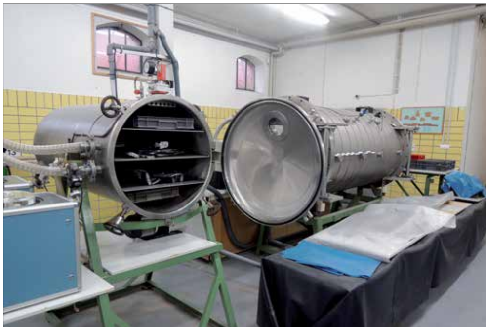
Obr. 38. Vákuové pumpy tvorili dôležitú súčasť procesu vysušenia a konzervácie dreva. Foto K. Pieta.
