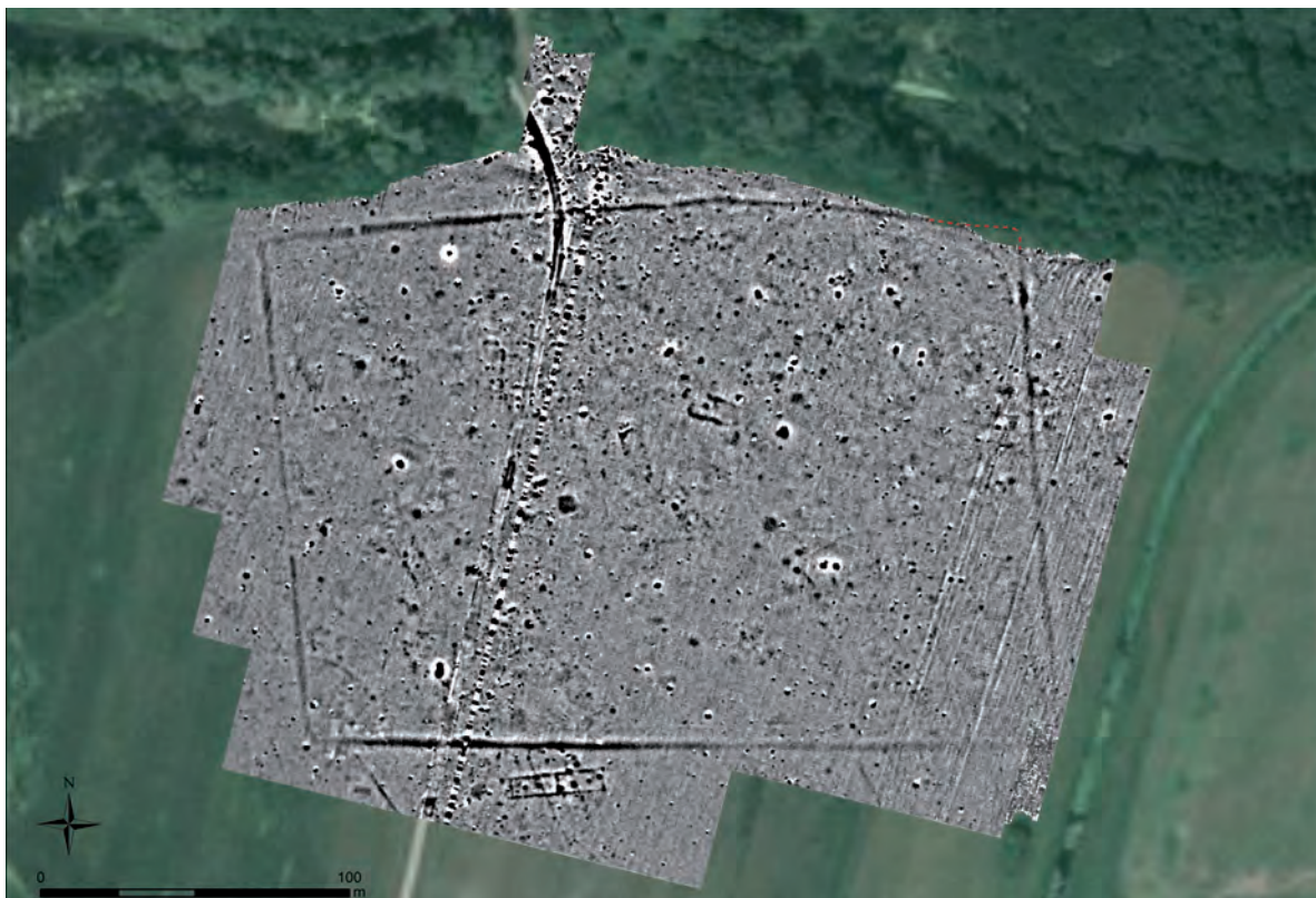
Obr. 4. Závod, okr. Malacky. Výsledný plán geomagnetických meraní s pôdorysom rímskeho tábora a dávnych sídliskových štruktúr. Spracovanie: M. Vlach, P. Červeň, Eurosense s.r.o.
